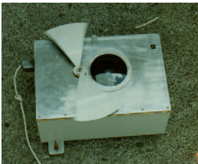
Figuur 3. All sky werk anno 1992. De behuizing is afkomstig van een oud all sky station van Hans Betlem.
