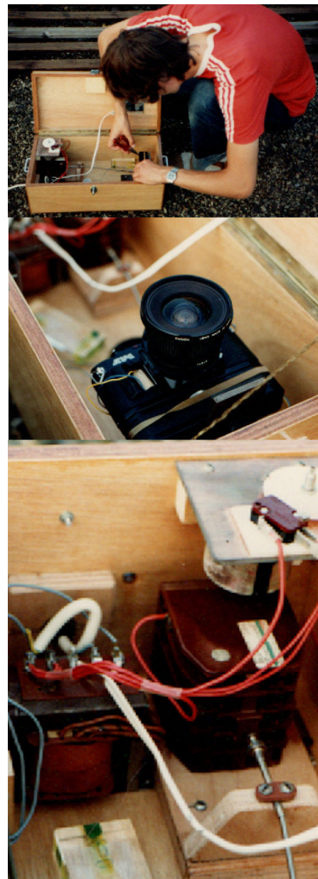
Figuur 1. De eerste 'all sky' camera in Harderwijk bestaande uit een Canon AV1 en een Canon FD 17 mm F 4.0 supergroothoeklens. Deze werd alleen tijdens waarneemacties ingezet. Aansturing gebeurde door de stroom van de Canon AV1 met winder te onderbreken. Dit gebeurde door een microswitch en een ronddraaiend schijfje met een kleine uitsparing. Deze draaide ééns in de 20 minuten rond. De maker Bauke Rispens optimaliseert hier de all sky camera.
