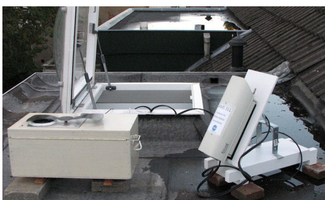
Figuur 4. De eerste digitale all-sky automaat (Canon 40 D en een Sigma f/2.8-4.5 mm en eerste CAMS systeem in Ermelo anno 2012.
