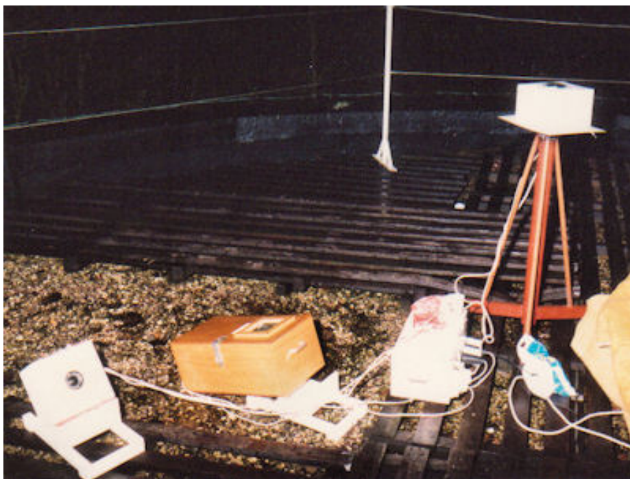
Figuur 2. Op een statief afkomstig van de WvS uit Denekamp staat hier een kistje met een Canon T70 en de Canon 7,5 mm F 5.6 lens. Geminiden 1984.
