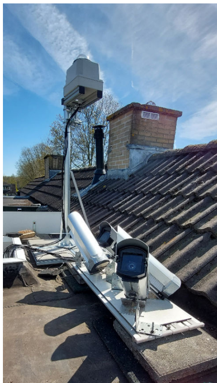
Figuur 7. De setup anno 2022 met de nieuwe 'Verstraaten'-behuizing en op de voorgrond 4 CAMS systemen.
