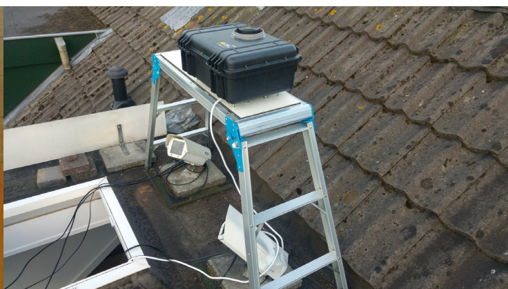
Figuur 5 en 6. EN908 anno 2017 met een Canon 6D met een Sigma 8 mm F 4.5 fish eye lens.
